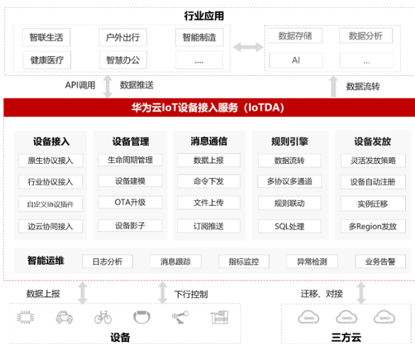
图 12 华为云采用分布式架构接入各行业应用
